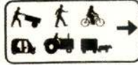
மெதுவாகச் செல்லும் வீதிப் பாவனையாளர்களின் திசையைக்காண் சைகை Direction Sign for Slow Moving Road Users
