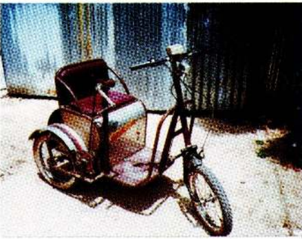
புதிதாக வடிவமைக்கப்பட்ட மின்கல சக்தியில் இயங்கும் முச்சக்கர வண்டி Newly Designed Power Operated Wheel Chair
