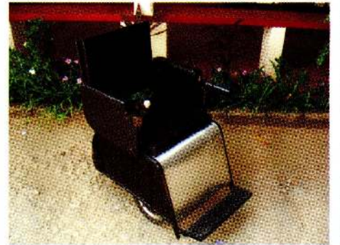
புதிதாக வடிவமைக்கப்பட்ட மின்கல சக்தியில் இயங்கும் சக்கர நாற்காலி Newly Designed Power Operated Wheel Chair
