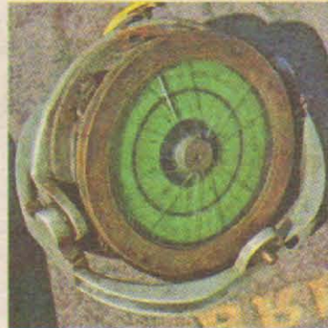
இதற்கு மேலதிகமாக விமானங்கள் கப்பல்களில் பயன்படுத்தப்படுவது Gyro Compass ஆகும். விலை மதிப்புடைய க்யூரோ திசையறிகருவி கோள வடிவத்தைக் கொண்டது.
