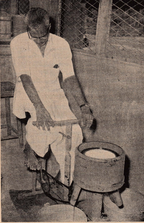
காலால் சுற்றி இயக்கும் இயந்திரத்தில் பாணியை இட்டு சீனியைத்தயாரிக்கும் முறையைச் செய்து காட்டுகிறார் திரு. ச. நாகலிங்கம் அவர்கள்.
