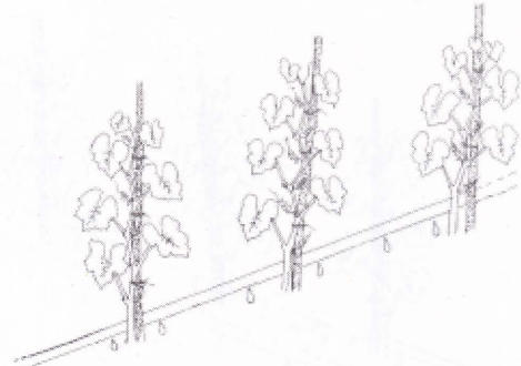
படம் 24 : ஒரு பக்கமாக இடப்பட்டுள்ள குழாய்களின் மூலம் சொட்டு நீர்ப்பாசனம்
