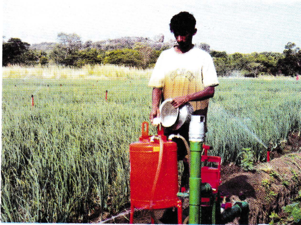
அழுக்க வேறுபாட்டினால் உறிஞ்சும் பம்பி (Pressure differential suction pump)
