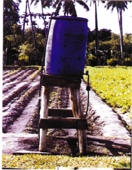
படம் 43 : வெளிக்களத்தில் நிர்மாணிக்கப்பட்டுள்ள பீப்பாய் கிட் புவியீர்ப்பு விசை சொட்டு நீர்ப்பாசனத் தொகுதி.
