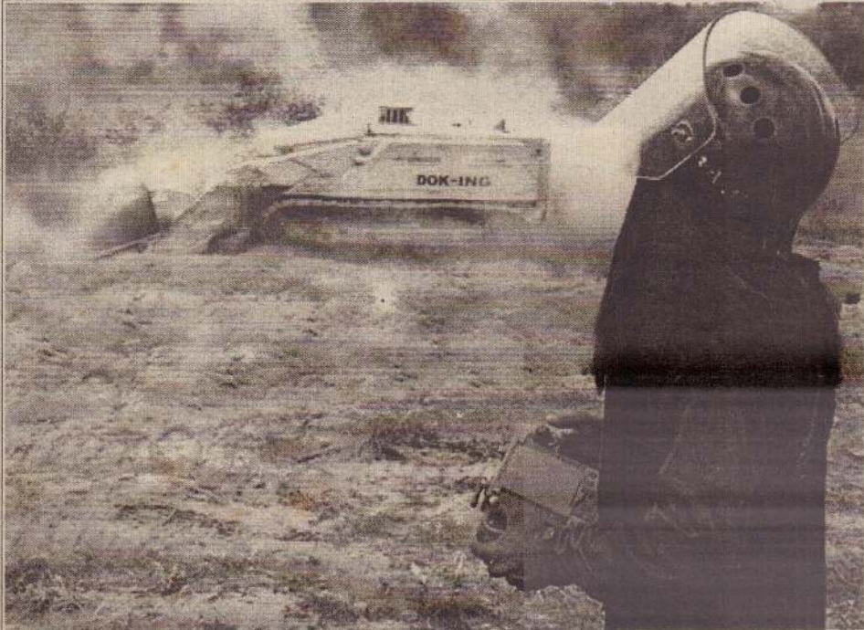
வன்னியில் இறுதிப்போர் நடைபெற்ற பகுதிகளில் கண்ணிவொடி அகற்றும் பணிகள் ஆரம்பிக்கப்பட்டுள்ளன. இந்தக் கண்ணிவொடி அகற்றும் பணியில் இராணுவக் கண்ணிவொடி அகற்றும் பிரிவு ஈடுபட்டு வருகிறது. நவீன இயந்திரங்களின் உதவியுடன் இந்தப் பணிகள் நடைபெறுகின்றன. கண்ணிவொடி அகற்றும் இயந்திரம் ஒன்றை 'றிமோட் கொன்ட்ரோல்' மூலம் இயக்குகிறார் படைச் சிப்பாய் ஒருவர்.
