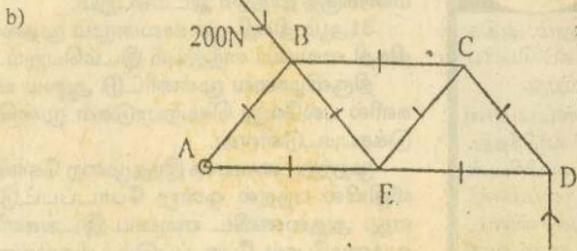
உருவில் காட்டப்பட்டுள்ள சட்டப்படலானது லேசான கோல்களால் ஆக்கப்பட்டுள்ளது. A யில் அச்சாணி ஒன்றுடன் பிணைக்கப்பட்டுள்ளது. BE வழியே 200N விசை பிரயோகிக்கப்படுகின்றது. D இல் சட்டப்படல் தாங்கப்பட்டுள்ளது. தாங்கி D இல் உள்ள மறுதாக்கத்தைக் காண்க. விசைப்படம் வரைவதன் மூலம் இழுவைகளையும் உதைப்புகளையும் வேறுபடுத்திக் காட்டி கோல்களில் உள்ள தகைப்புகளைக் காண்க.
