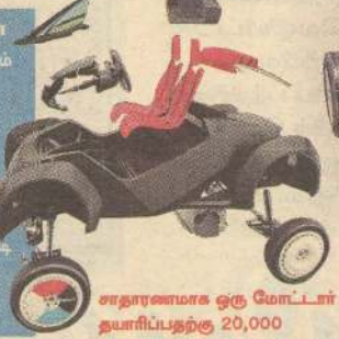
03 ஸ்ட்ராட்டி காரின் மின்குமிழ், டேஷ் போட், கண்ணாடிகள் மற்றும் இரு ஆசனங்கள் என்பன தெளிவாக தெரியக்கூடிய விதத்தில் அச்சு நடவடிக்கைகள் மேற்கொள்ளப்பட்டுள்ள விதம்.
